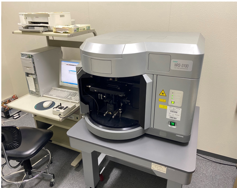
香川大学創造工学部の顕微ラマン分光装置 (日本分光・NRS-3100)
